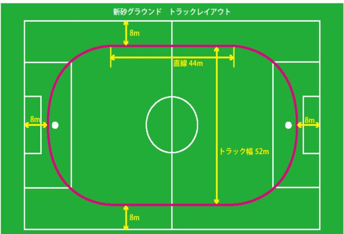
タッチラインより内側 8m の地点をストレートとし、ゴールライン中央より 8m の地点をカーブの頂点とする。 ストレートの長さは 44m としストレートの終点とカーブの頂点を緩やかなカーブで繋ぎトラックを形成する。
